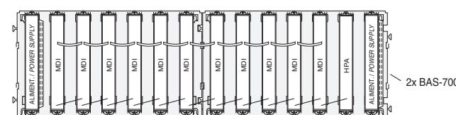
Les schémas montrent deux exemples d'emplacement des modules composants d'une station MDI. L'amplificateur HPA doit être placé au fin de la cascade de transmodulateurs. Les alimentations doivent être placées toujours dans les cotés de l'ensemble. Quand la table NIT sera adaptée, on devra installer le bus IKUSUP entre modules. Le dernier transmodulateur au bout droit effectuera la fonction de contrôle.
